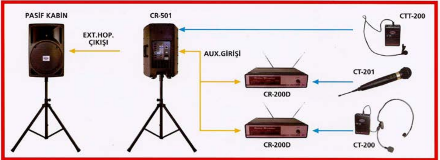
CR-501 TELSİZ HOPARLÖR İLE AYNI ANDA 3 ADET ORIENT TELSİZ MİKROFON KULLANABİLME
